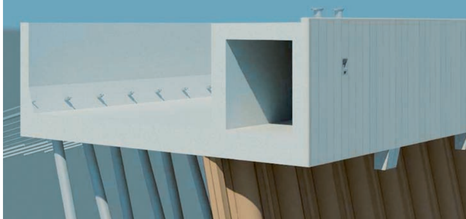
Staalvezelversterkte hogesterkte betonnen prefab panelen geïntegreerd in de bovenbouw
